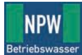
Рисунок 86: Приклади маркування труб згідно з DIN 2403
